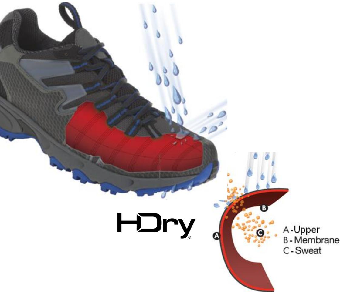
**La membrana** impermeabile e traspirante HDry **viene laminata** (incollata con micropunti 'hot-melt' mediante pressatura in 3D) **direttamente sul lato interno della tomaia.**
